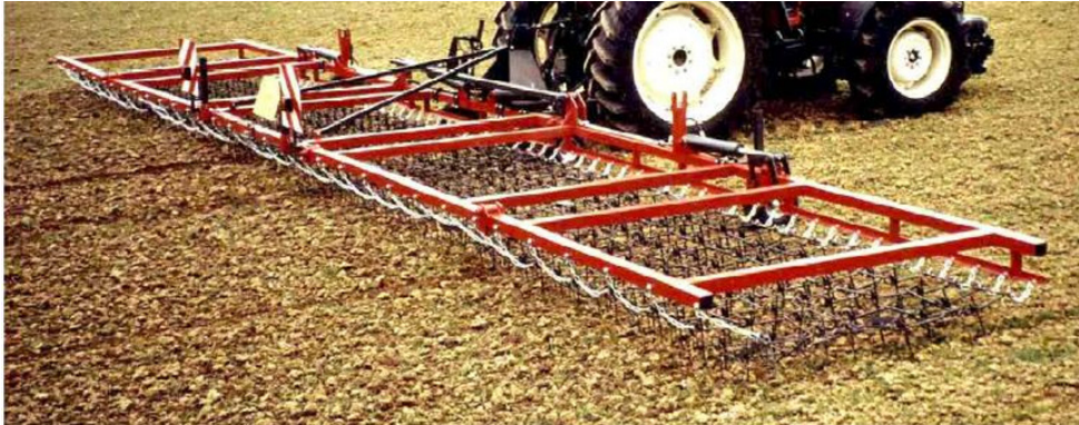
Abbildung 2.1: Zinkenstriegel. Quelle: Magdalena Lacko-Bartosova.
