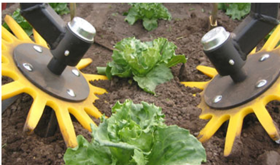
Abbildung 2.2. Fingerhacke (Kress). Quelle: Kress.
