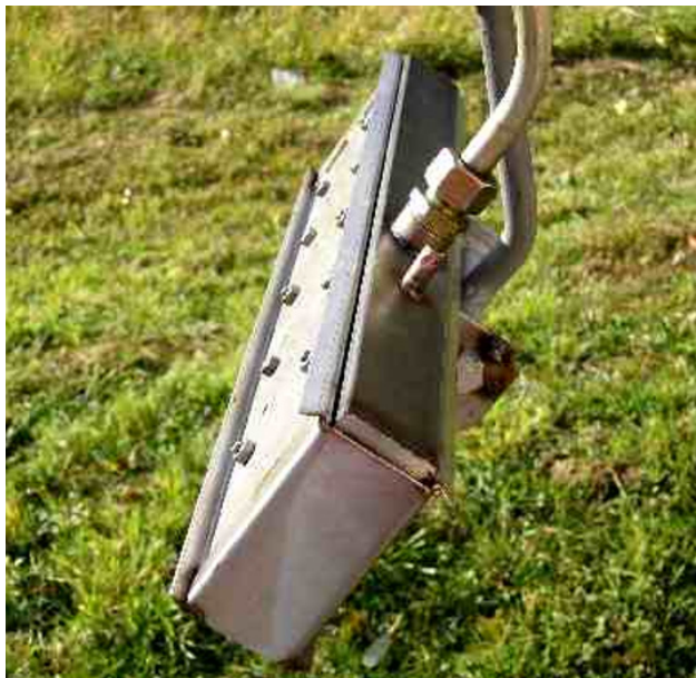
Abbildung 2.4. Unkraut Brenner. Quelle: Magdalena Lacko-Bartosova.
