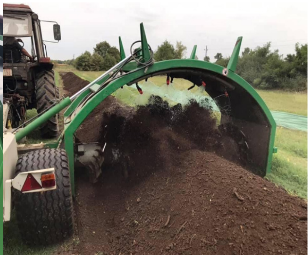
Abbildung 1.2. Kompostwender im Einsatz. Quelle: Tibor Petró.
