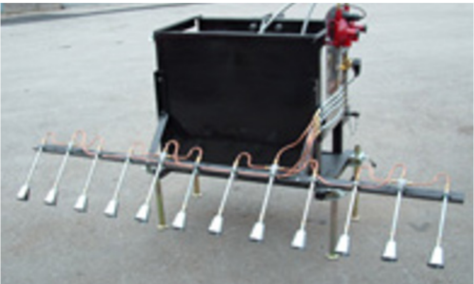
Abbildung 2.6. Unkraut Brenner. Quelle: Magdalena Lacko-Bartosova.
